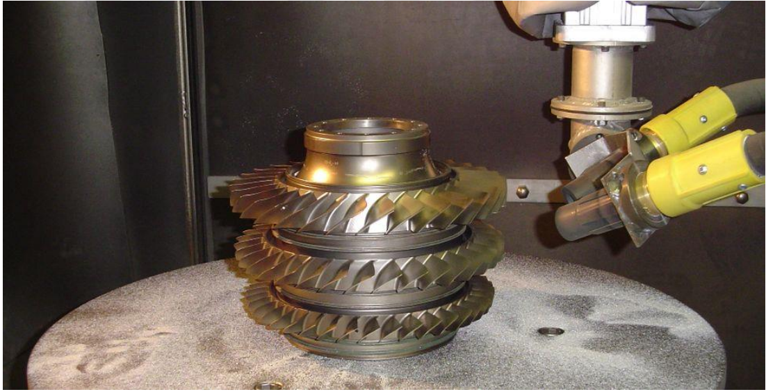
Şekil 6.2. Gaz türbinli motor kompresör kısmının bilyeli püskürtme işlemi [2]
