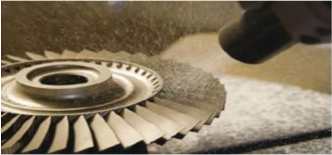
Şekil 6.1. Türbin kanatçıklarının bilye püskürtme ile yüzey işleme
