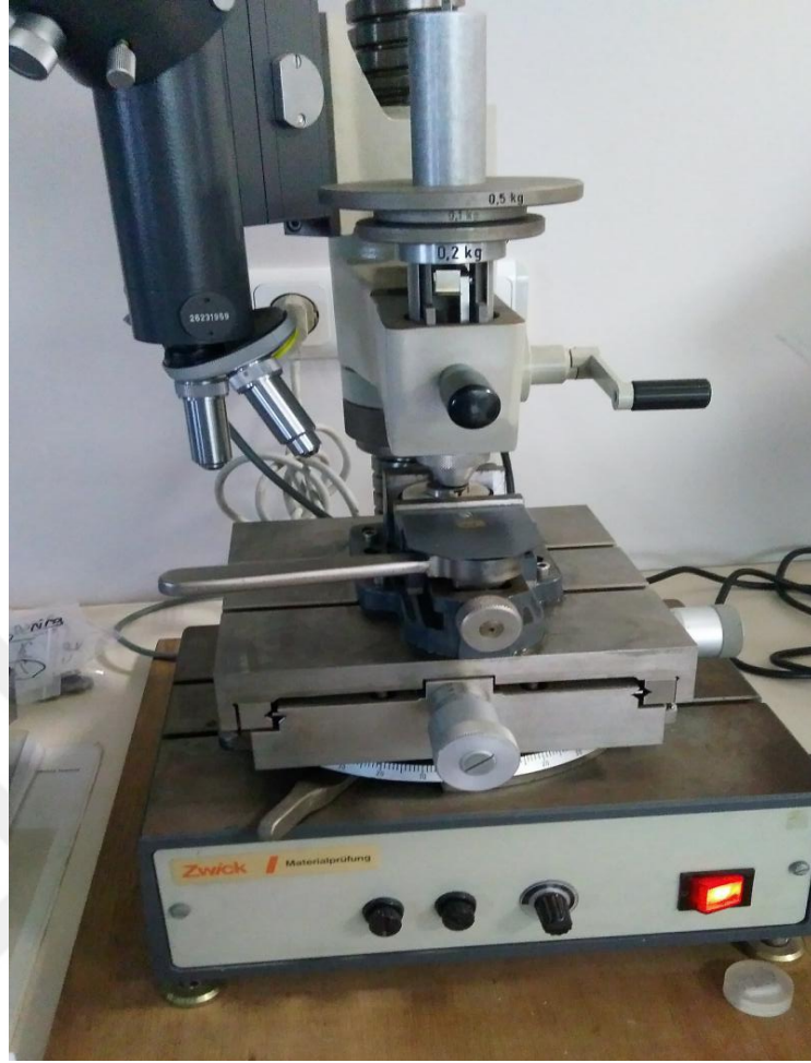
Şekil 7.7. Yüzey sertlik ölçümü iz oluşturma cihazı
