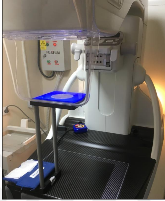
Şekil 2.18. Odak noktası boyutu ölçüm düzeneği
