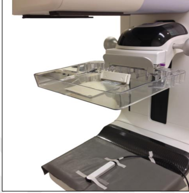
Şekil 2.19. HVL ölçümü deneysel kurulum
