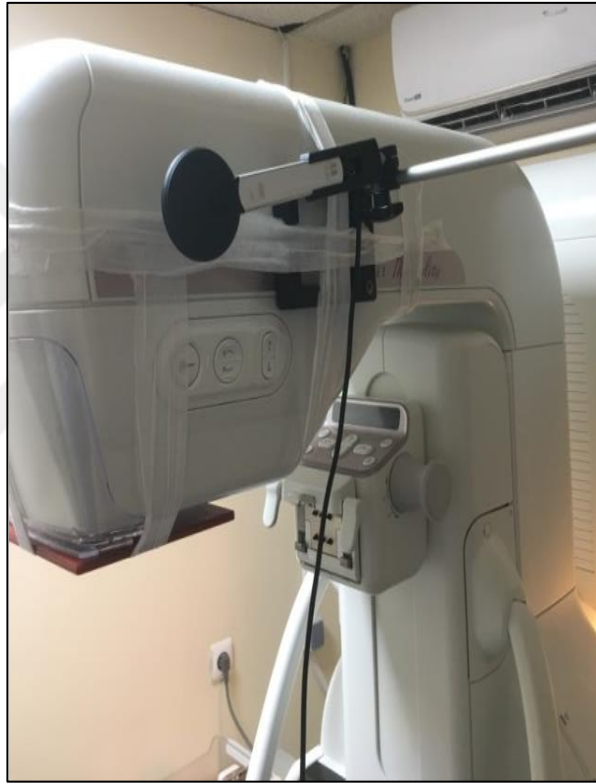
Şekil 2.16. Sızıntı radyasyon test düzeneği
