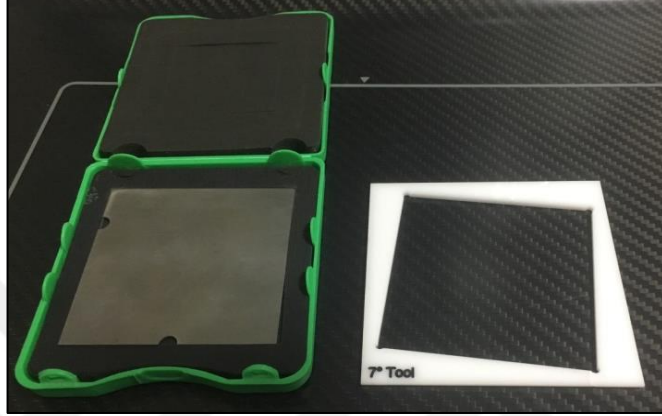
Şekil 2.11. Tungsten kenar test objesi
