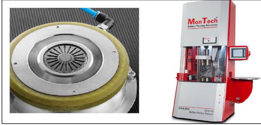
Şekil 1.46. Örnek bir RPA cihazı kabini ve kalıp geometrisi
