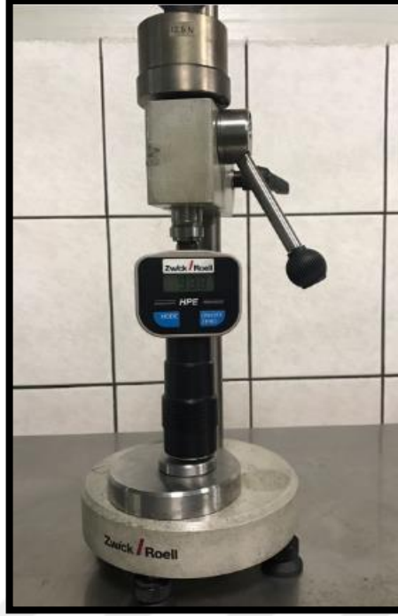
Şekil 5.7. Zwick marka sertlik ölçer
