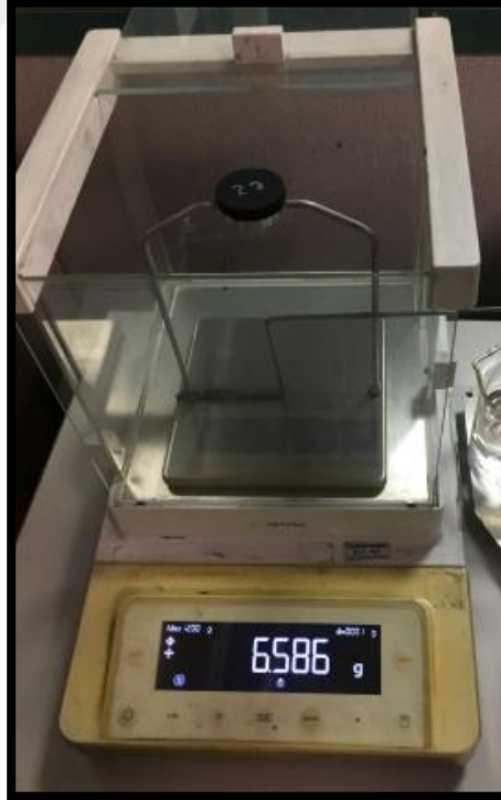
Şekil 5.6. Sartorius marka yoğunluk ölçüm terazisi
