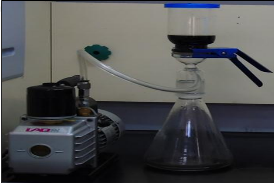
Şekil 3.3. Filtrasyon yöntemi ile GO ve GR-MO film üretiminde kullanılan vakum filtrasyon sistemi fotoğrafı
