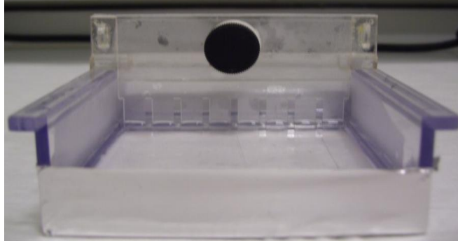
Şekil 2.1. Polimerleşmeye bırakılmış yatay SDS-poliakrilamit jel
