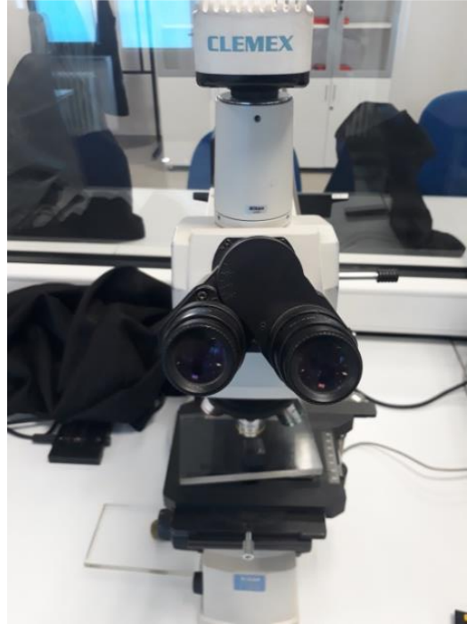
Şekil 5.2. Mikroyapı incelemelerinde kullanılan Nikon mikroskop
