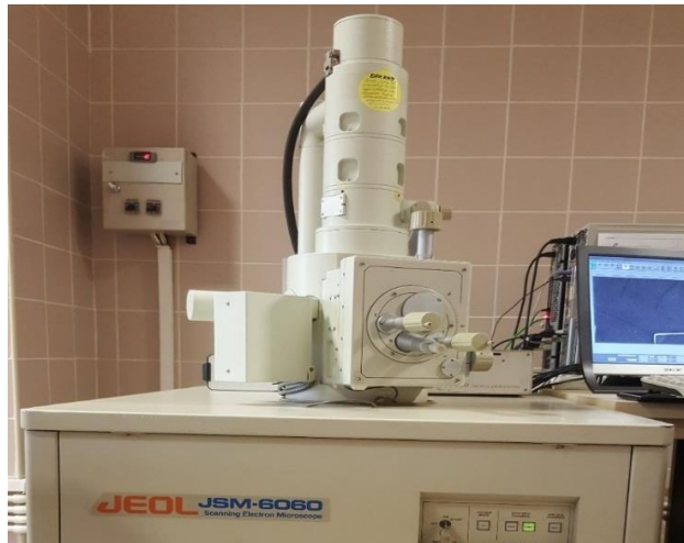
Şekil 5.9. JEOL JSM-6060 marka taramalı elektron mikroskobu
