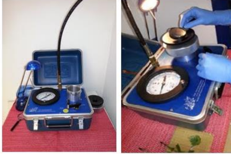
Şekil 4.6 Basınç Bombasında (Pressure Bomb, Pms Instruments) Yaprak Su Potansiyeli Ölçümü
