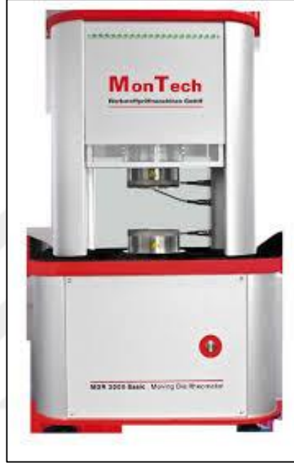
Şekil 3.1. MonTech MDR 3000 Basic reometre cihazı
