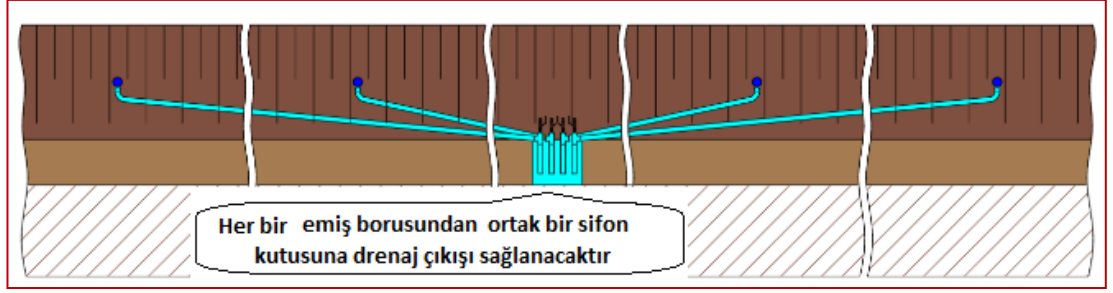
Şekil 5.26. E.B.7'den E.B.10'a kadar olan rigollerin ortak sifon akışı (Seyfert ve Elfruth, 2017).
