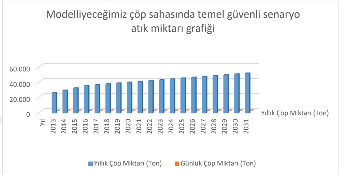
Şekil 5.10. Modelliyebileceğimiz çöp sahasının temel güvenli senaryoda (senaryo-1) çöp miktarlarının yıllara bağlı değişimini gösteren grafiksel bilgi
