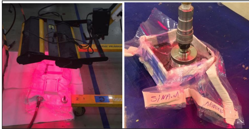
Şekil 2.7. A, B ve C numunelerinin 90 °C sıcaklık ve 7 bar vakum altında 4 saat süren kür işlemi.
