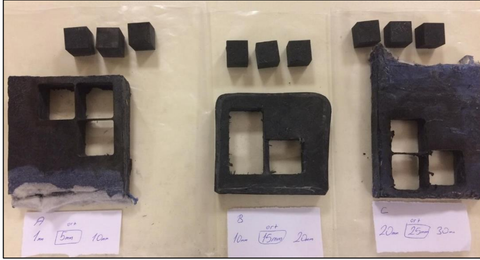
Şekil 2.12. Aşınma testi için karma fiberlerden oluşan A, B ve C grubu numuneleri
