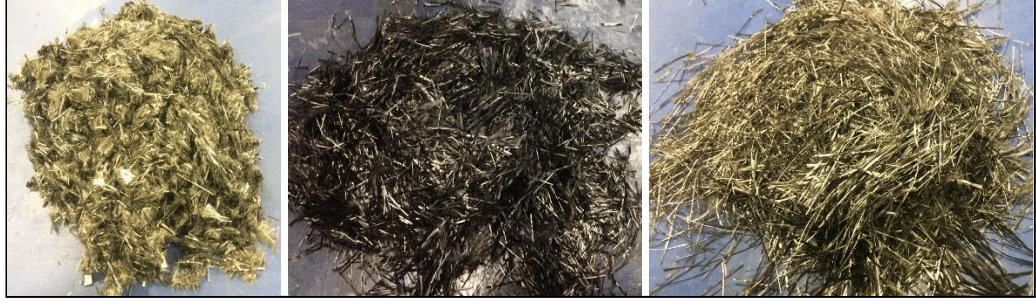
Şekil 2.5. Ortalama boyut dağılımı sırası ile 5, 15 ve 25 mm olarak kesilen karbon fiberler.
