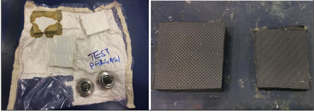
Şekil 2.3. Otoklav sisteminden çıkarılan numunelerin vakum torbasındaki görünümü (sol) ve vakumdan çıkarılan kürlenmiş prepreg numuneler.
