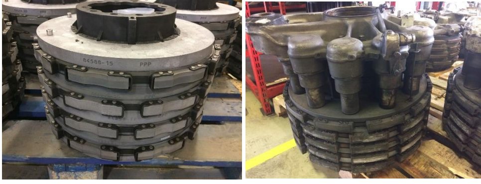
Şekil 1.27. Kullanılmamış yeni karbon frenleri (sol), aşınmış karbon frenleri (sağ).
