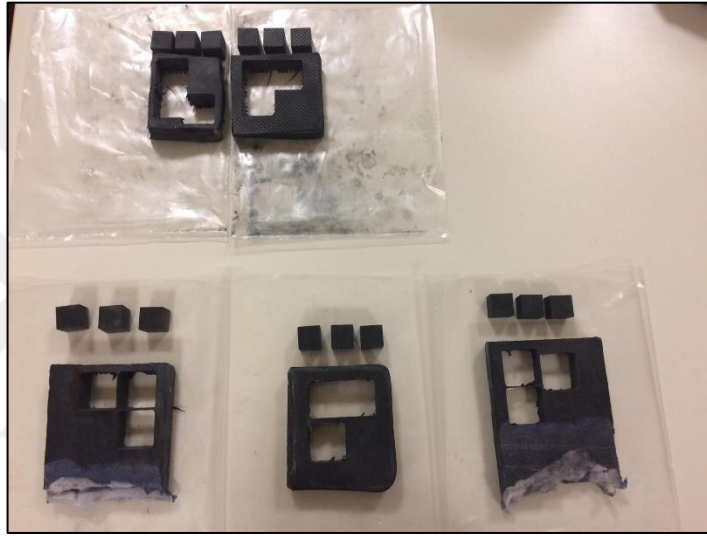
Şekil 2.8. CNC cihazında otomasyon yöntemi ile hassas kesimleri yapılan 2x2x2 cm boyutlarındaki test numuneleri.
