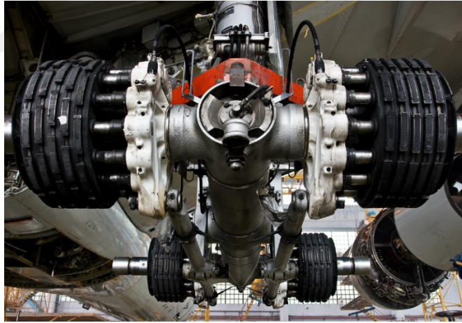
Şekil 1.15. Airbus A330 sol iniş takımında karbon fren sistemlerinin görünümü.
