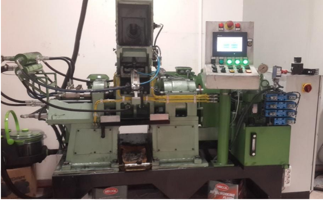
Şekil 3.1. Tanjential rotora sahip 2 litre hacimli hamurların hazırlandığı banbury
