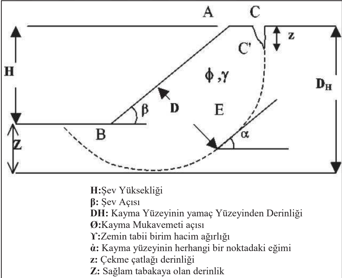
Şekil 1.3. Bir şevin geometrik özellikleri
