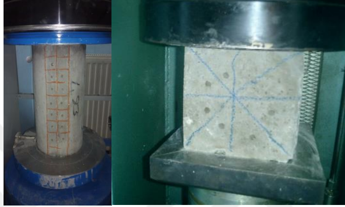
Şekil 3.8. Schmidt yüzey sertliği okuması için numune işaretlemeleri
