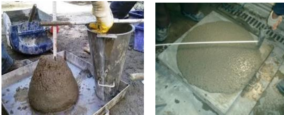
Şekil 3.3. Slump (solda) ve yayılma (sağda) deneyleri
