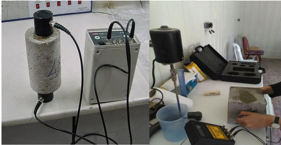
Şekil 3.10. Ultrasonik geçiş hızı test uygulamaları
