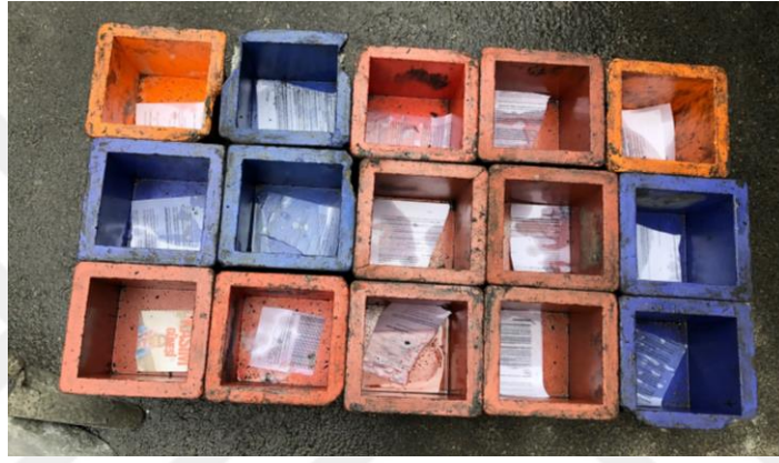
Şekil 1.4. Hasar görmüş yerli numune kalıp görünümü
