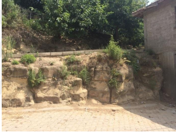
Şekil 3.15. Kandıra İlçesi güneydoğusunda ki Pelitpınarı köyü'ndeki ince taneli, sert, zor kırılan ve 0.5-2 mt. tabaka kalınlıklarındaki masif kumtaşı görüntüsü ( Gps: 40°59'23.26''K, 30°12'30.53''D )
