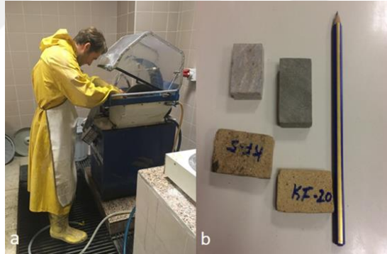
Şekil 2.1. (a) Örnek hazırlama laboratuvarında numunelerin plakalar halinde kesme işlemi. (b) numunelerin plakalar haline getirilmiş halini gösterir
