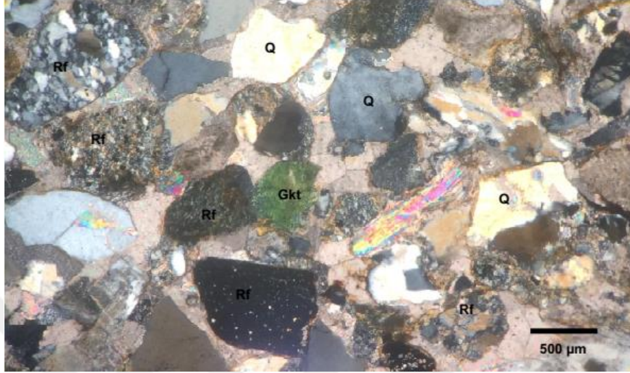
Şekil 3.21. Kandıra İlçesi Macarlı Köyü tarafından alınan örnek üzerinde gözlenen glokonit mineralinin görüntüsü. (Gps: 41° 0'12.30"K, 30°12'11.09"D)
