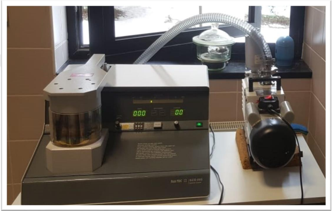
Şekil 4.9. BAL-TEC SCD-005 Marka püskürtmeli kaplama cihazı
