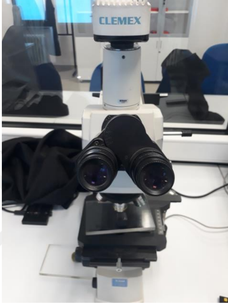
Şekil 4.2. Mikroyapı arařtırmalarında kullanılan nikon mikroskop
