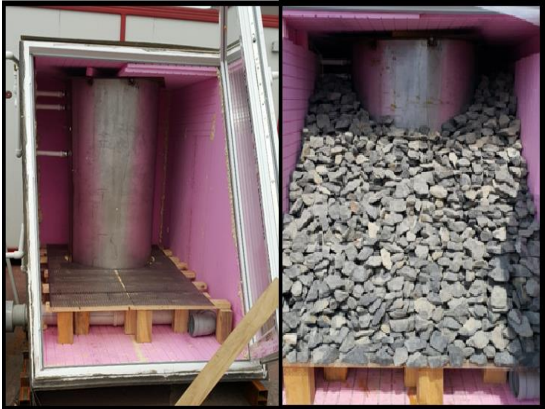
Şekil 4.5. Isı deposu içerisinde bulunan tank, önden görünüş, taşlarla dolu ve boş hali
