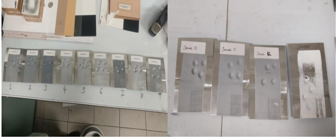
Şekil 4.24. Kabaran alev geciktiricili boyaların darbe dayanımları testi sonrası görüntüleri
