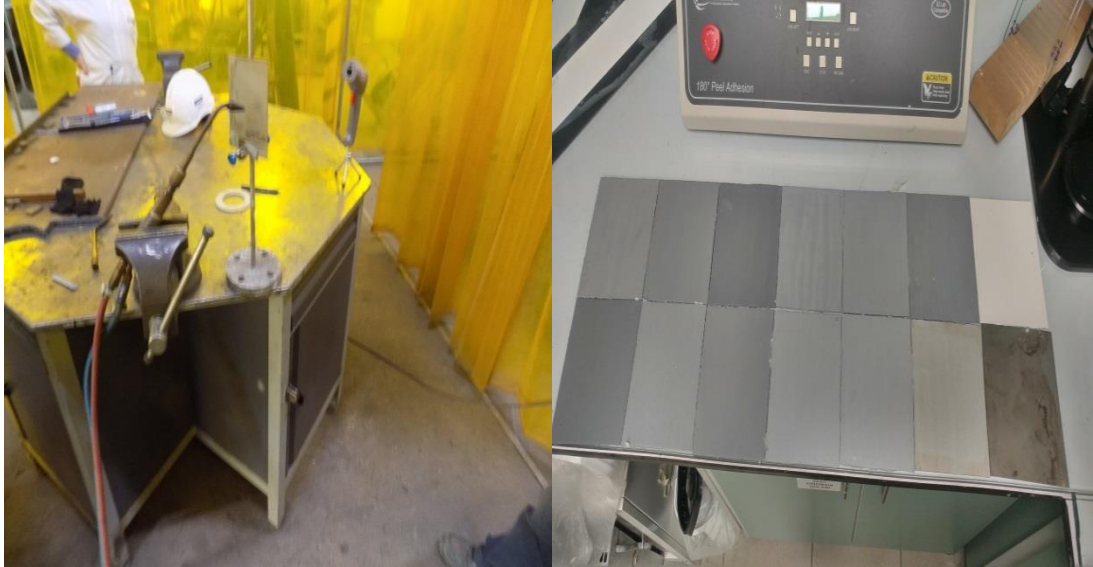
Şekil 3.3. Alev dayanım test düzeneğinin detayları ve uygulanan çelik paneller
