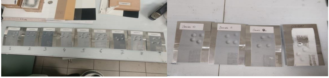
Şekil 4.25. Kabaran alev geciktiricili boyaların yapışma testi sonrası görüntüleri
