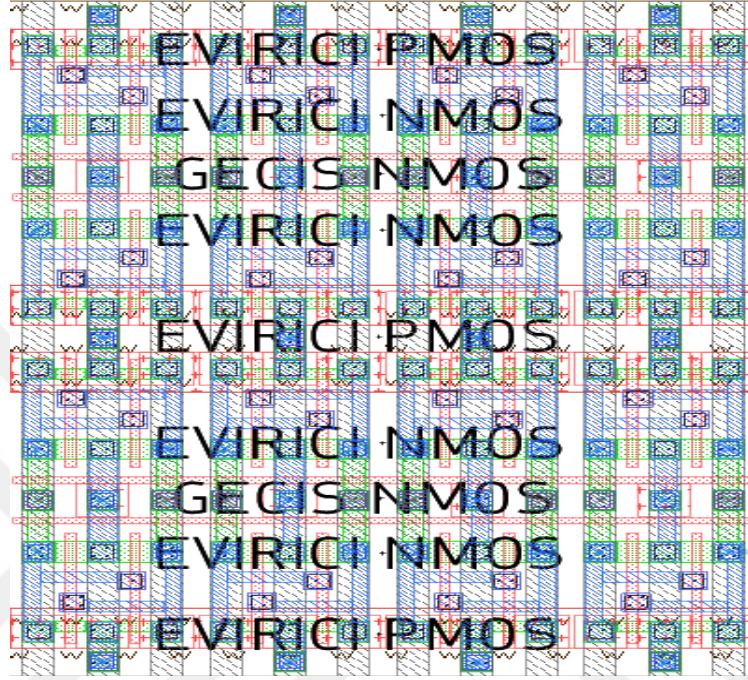
Şekil 1.26. 4x4'lük SRAM birim hücre serimi 1 dizisi
