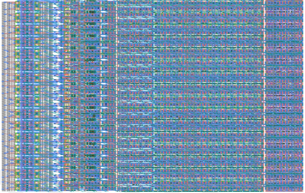
Şekil 2.5. 32 satır içeren satır çözücü devresi serimi
