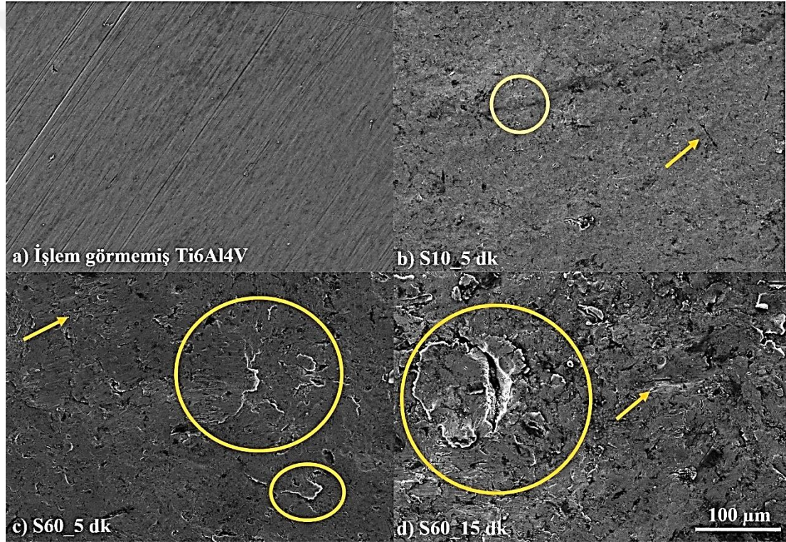
Şekil 5.30. Bilyalı dövme sonrası yüzeylerin SEM incelemesi a) işlem görmemiş Ti6Al4V alaşımı, b) S10_5 dk, c) S60_5 dk, d) S60_15 dk
