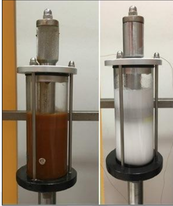
Şekil 2.18. Hematit kaplanmış küre içeren (solda) ve kaplanmamış cam küre içeren (sağda) sıvıların damper içindeki görünüşü
