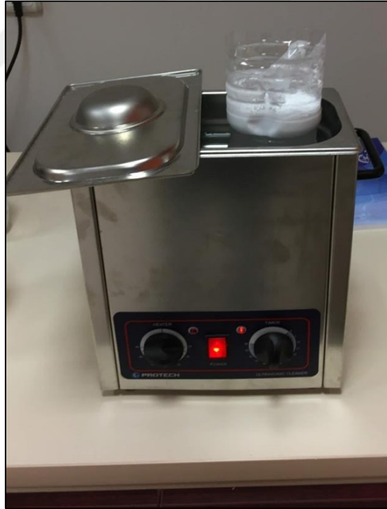
Şekil 2.11. 0,5 M NaOH solüsyonunda içi boş cam kürelerin ultrasonik temizleyicide temizlenmesi işlemi
