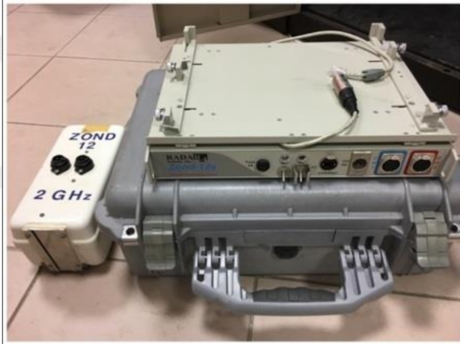
Şekil 4. 1. Yer radarı uygulamalarında kullanılan Zond-e cihazı ve 2 GHz merkez frekanslı ve korumalı anteni
