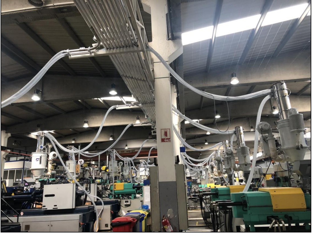
Şekil 2.33. Hammaddeleri Tezgahlara Taşıyan Borulama Sistemi
