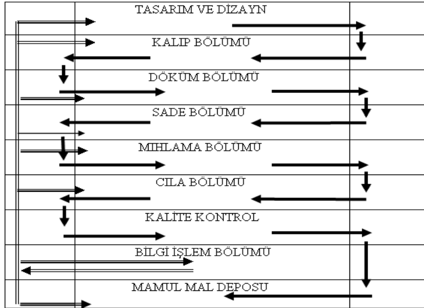
Şekil 4. Mücevher Eşya Üreten Kuyumcu İşletmelerde Üretim Akış Şeması
