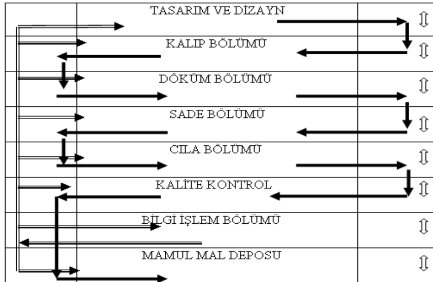
Şekil 3. Altından Mamul Eşya Üreten Kuyumcu İşletmelerde Üretim Akış Şeması
