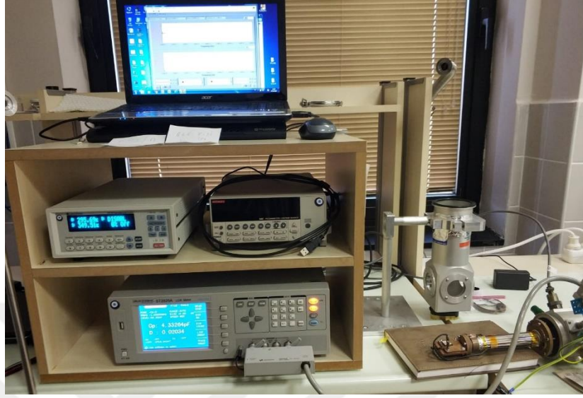
Şekil 2.13. Elektriksel iletkenlik ölçümlerinin gerçekleştirildiği düzenek
