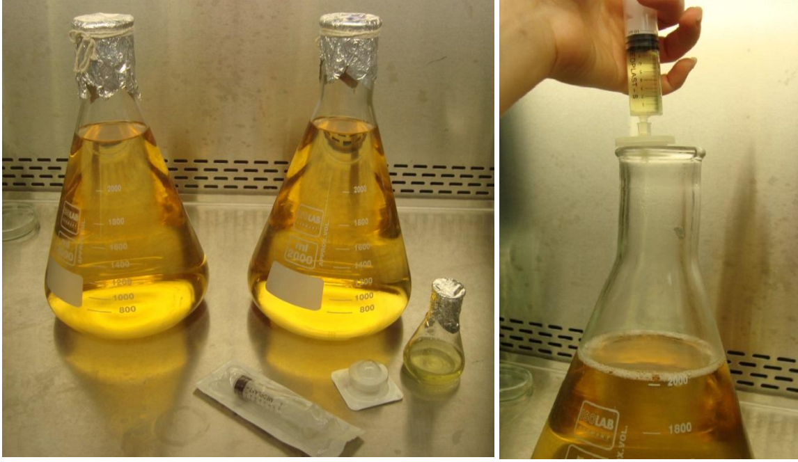
Şekil 3.11. Otoklavdan çıkmış ve sıcaklığı 70 °C civarına düşmüş besin ortamına, aseptik koşullar altında kolhisin çözeltisinin filtre sterilizasyonu yoluyla ilave edilmesi
