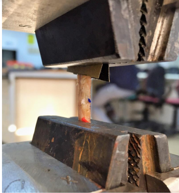
Şekil 3.3. Çekme testi cihazının çeneleri arasına yerleştirilmiş bir deri örneği
