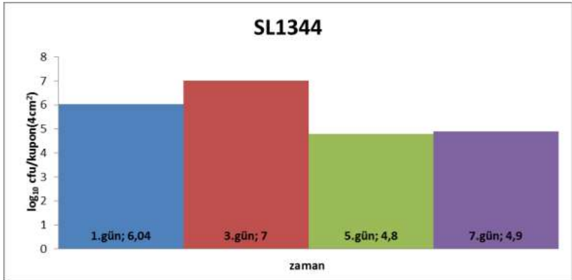
Şekil 5.2. S. Typhimurium SL1344 suşunun galvenizli paslanmaz çelik yüzey üzerinde biyofilm oluşturma özelliğinin zamana bağlı değişimi
