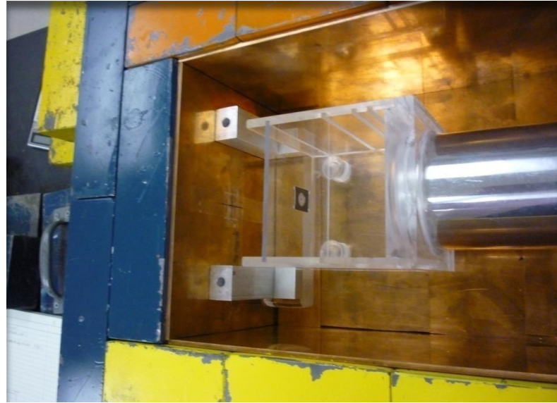
Şekil 3.3. Notre Dame Üniversitesi (USA) Nükleer Bilimler Araştırma Laboratuvarı gama dedektör sisteminde belli bir geometriyi sabit tutmak için kullanılan hedef tutucu
