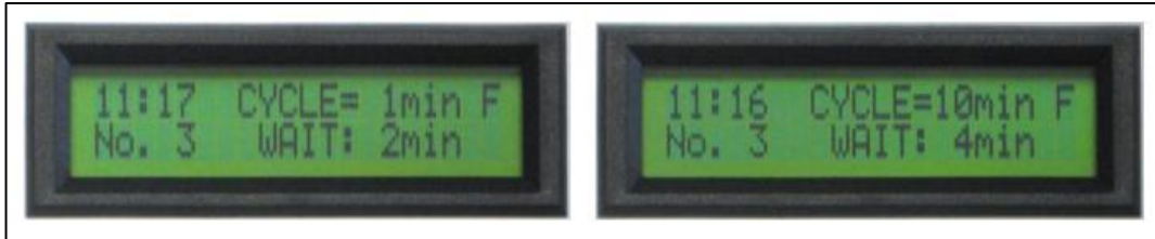
Şekil 2.12. Akış modu (sol: 1 dak, sağ: 10 dak döngüsü) [31]
