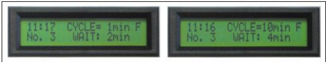
Şekil 2.16. Başlatma aşamasından sonraki AlphaGUARD ekranı - Akış modu (sol: 1 dakika, sağ: 10 dakika döngü) [31]
