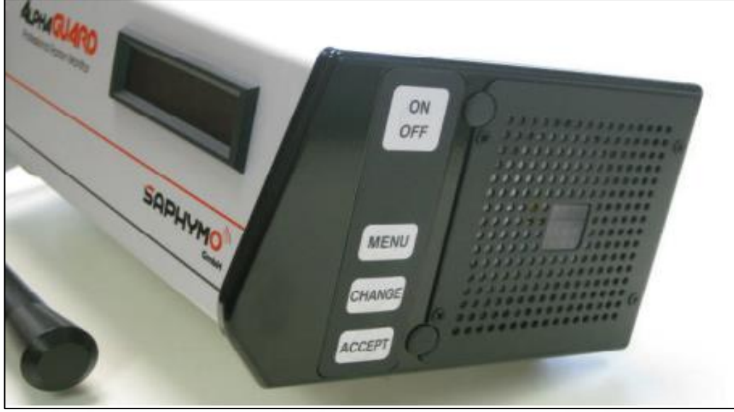
Şekil 2.10. Difüzyon modu: vidalı kapak sökülmüş, koruyucu ızgaraya takılmış hali
