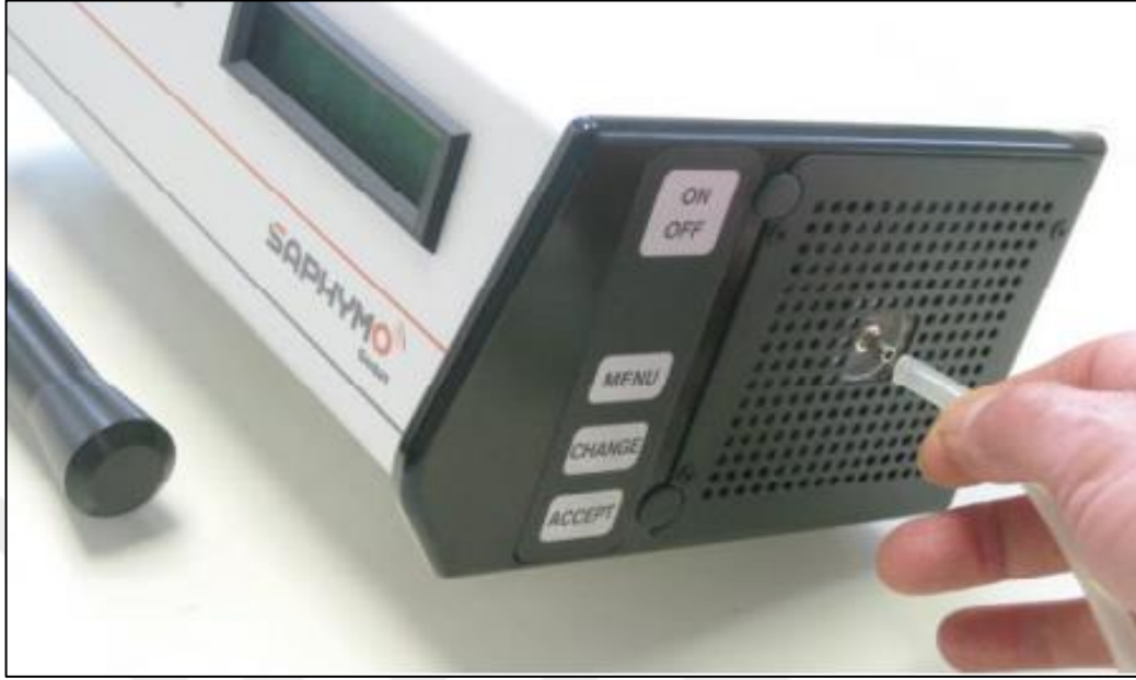
Şekil 2.13. Akış modu: vidalı kapak, koruyucu ızgaraya takılmış hali [31]
