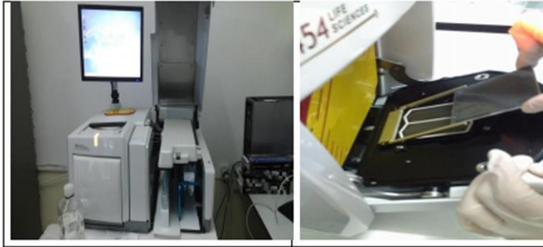
Şekil 4.5. Dizilemede kullanılan Roche 454 FLX+ cihazının hazır hale getirilmesi ve PicoTiter Plate'in yüklenmesi
