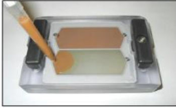
Şekil 2.11. Boncukların PicoTiterPlate aparatına yüklenmesi ( http://454.com/Apr2014 )’den değiştirilmiştir)
