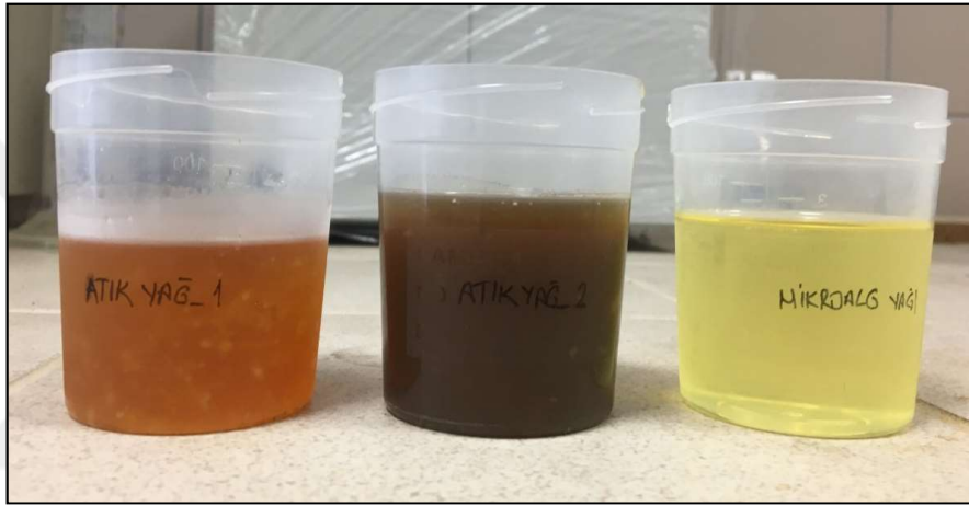
Şekil 4.2. Transesterifikasyon reaksiyonunda hammadde olarak kullanılan Atık Yağ_1, Atık Yağ_2 ve Mikroalg yağları
