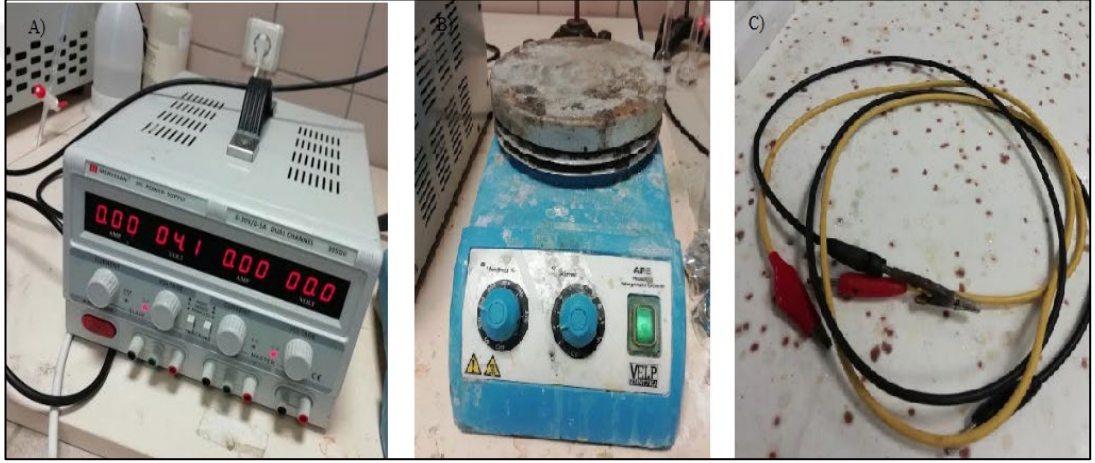
Şekil 4.1. Kaplama işlemi yardımcı elemanlar A) DC güç kaynağı, B) Manyetik karıştırıcılı ocak, C) Bağlantı elemanları.
