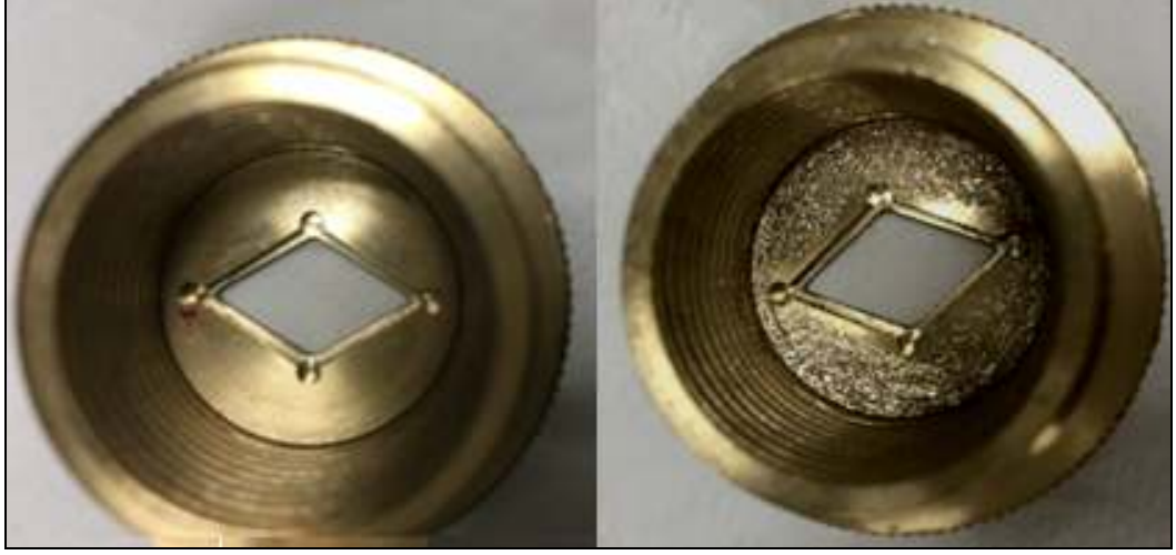
Şekil 2.12. PZT yuvasının pürüzlü iç yüzeyi
