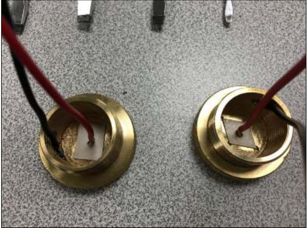
Şekil 2.13. PZT yuvasına yerleştirilmiş dönüştürücü
