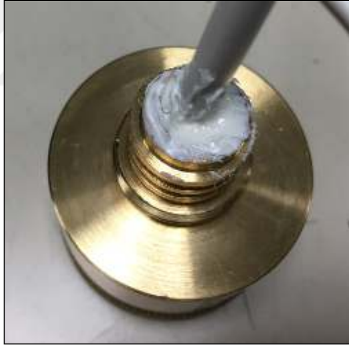
Şekil 2.19. Arka gövdeye su yalıtımı işlemi
