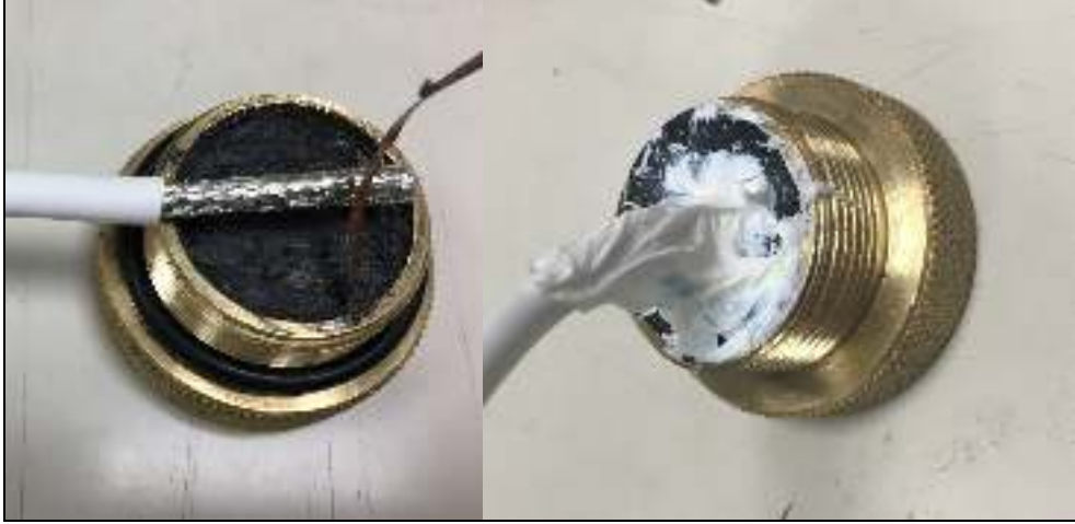
Şekil 2.18. Su yalıtımı yapılmış PZT yuvası
