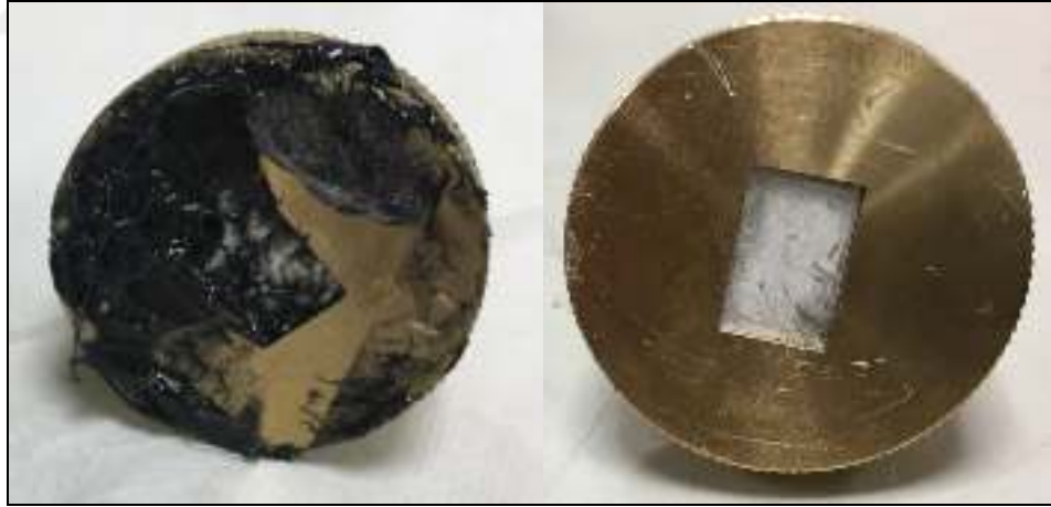
Şekil 2.17. Destekleme malzemesi yapışmış ve temizlenmiş PZT yuvası
