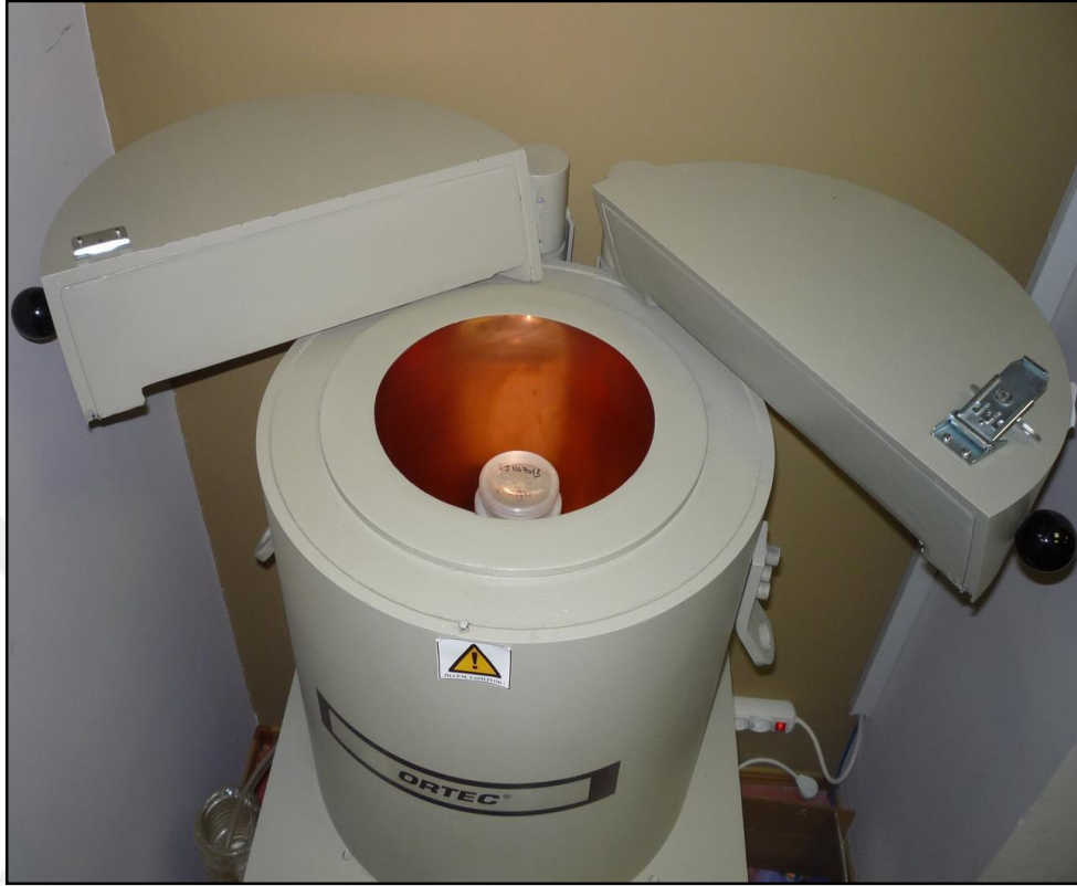
Şekil 2.5. HPGe Dedektörünün açık ve üstten görünümü [20]
