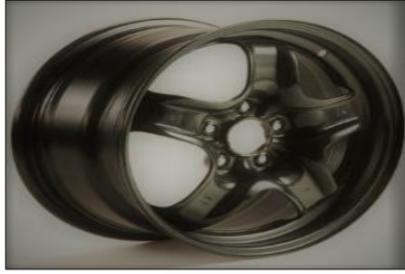
Şekil 2.10. FB çeliğinden üretilmiş jant [27]
