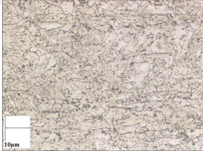
Şekil 2.9. CP çeliğinin mikroyapı görüntüsü [27]
