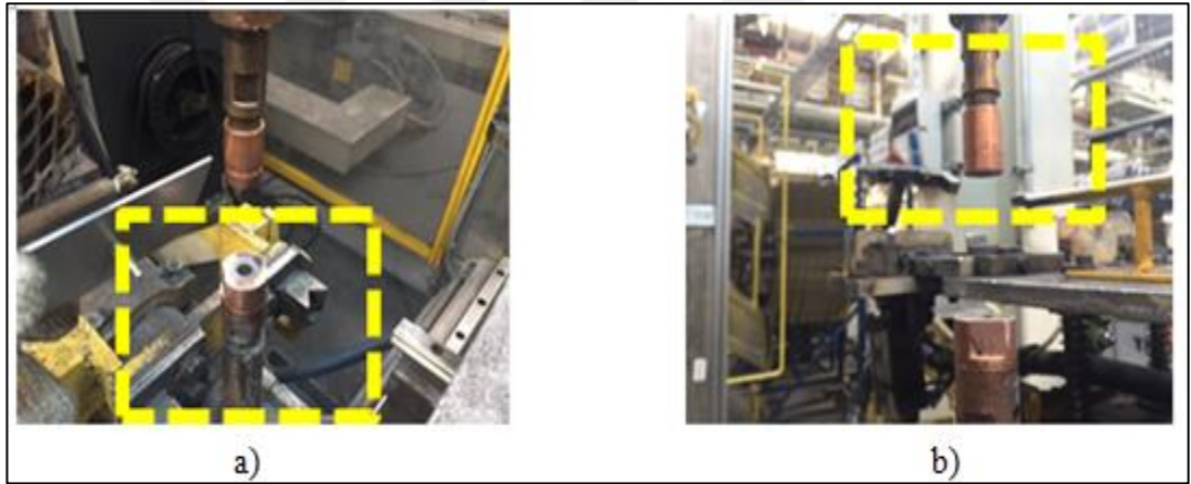
Şekil 3.9. Kaynak elektrotları a) Alt elektrot, b) Üst elektrot
