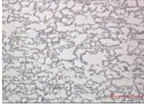
Şekil 2.14. TRIP çeliğinin mikro yapı görüntüsü [27]
