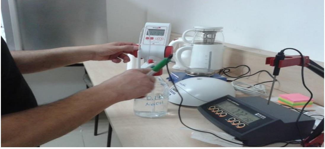
Şekil 2.8. Titr edilebilir asitlik değeri ölçümü için hazırlanmış numuneler ve ölçümün yapılışı
