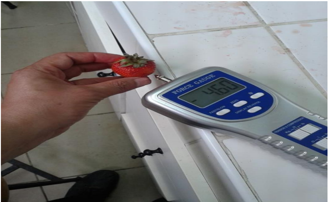
Şekil 2.5. Meyve eti sertliđi ölçümü
