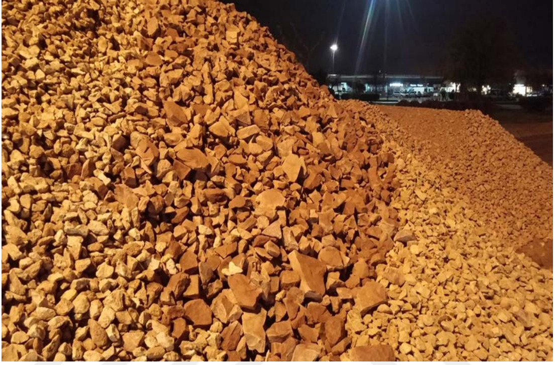
Şekil 3.18. Taş kolon için uygun malzeme
