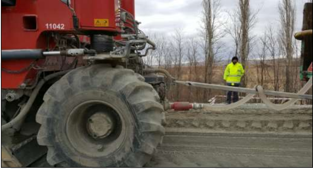
Şekil 3.6. Önünde çeki demiri bulunan frezeleme makinesi
