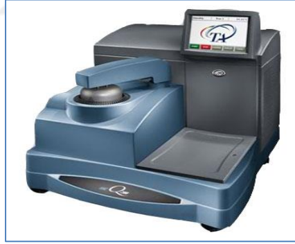
Şekil 6.1.TA Instruments Q200 Model DSC cihazı [31]
