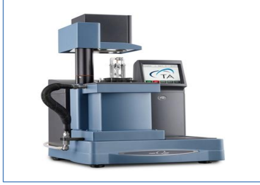
Şekil 6.2.TA Instruments Q800 model DMA cihazı [32]
