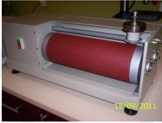
Şekil 6.3. Ektron marka EKT-2103 model aşınma cihazı [33]
