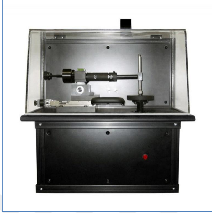
Şekil 6.4.Nanovea adhezif aşınma cihazı [34]
