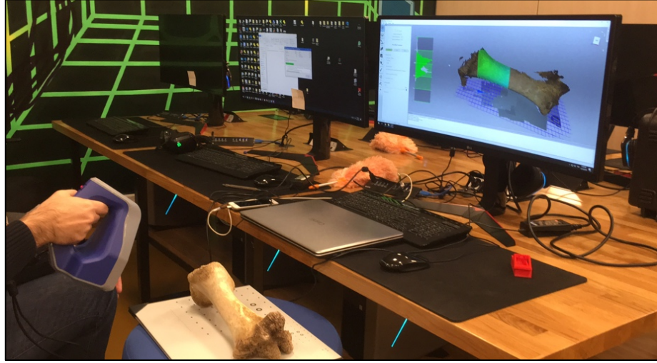
Şekil 5.15. Artec Space Spider marka 3B tarayıcı ile tarama işlemi
