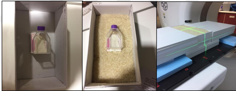
Şekil 6.1. Fantom içine hücre ekili flaskın yerleşimi, (b) Pirinç ile tamamen doldurulması, (c) CT taraması için işaretleme ve tarama.
