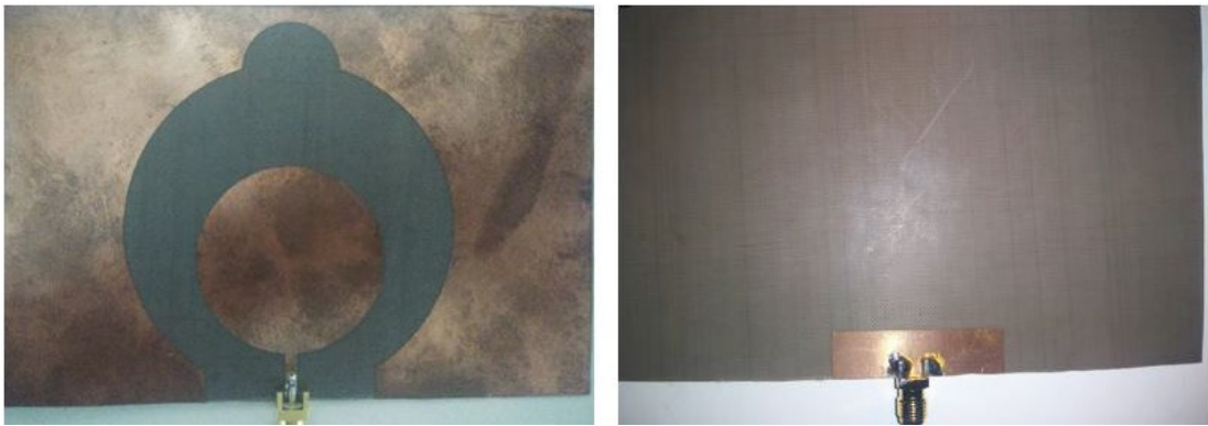
Şekil 5.1. Antenin baskı devre görüntüsü.
