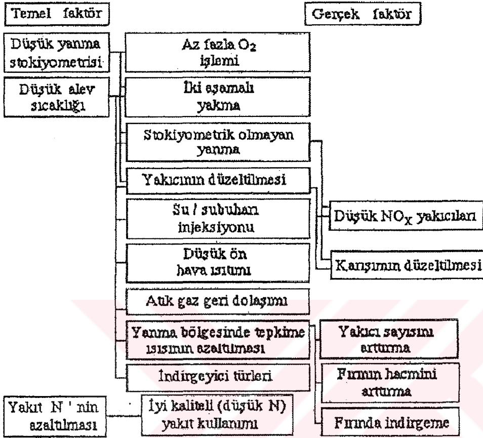
Şekil 2.4. Yakma düzenlerinde modifikasyonla NO x emisyon kontrolü (Bosch and Janssen, 1988; Ishimoto and Miyamae, 1985).
