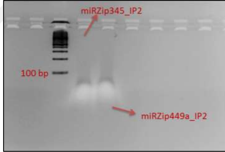
Şekil 5.55 miRZip345 IP ve miRZip449a IP ikinci teknik tekrar örneklerine ait cRNA jel görüntüleri. Görüntü örneklerin %3'lük agaroz jelde 120 V 30 dakika yürütülmesinden sonra elde edilmiştir. 100 bp markır kullanılmıştır
