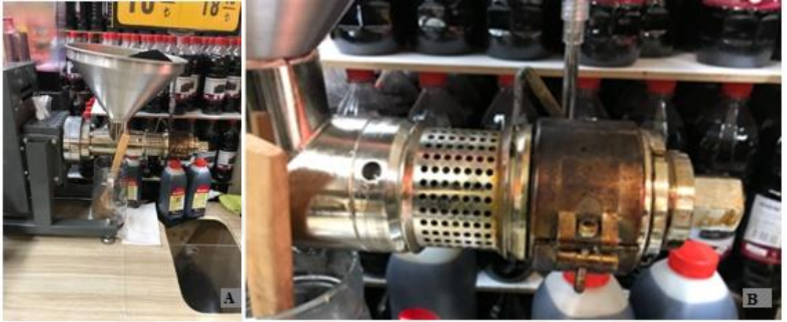
Şekil 6. 2. Çörek otu tohumundan yağ elde etmek için kullanılan soğuk pres makinesinin genel görünümü (A) ve makinenin dikkat edilmediğinde fazla ısınıp, yağın yüksek ısıya maruz kalarak yanmasına sebep olan parçasının (B) görünümü ( Fotoğraf Prof. Dr. Maksut Coşkun tarafından çekilmiş olup izinleri alınarak kullanılmıştır)
