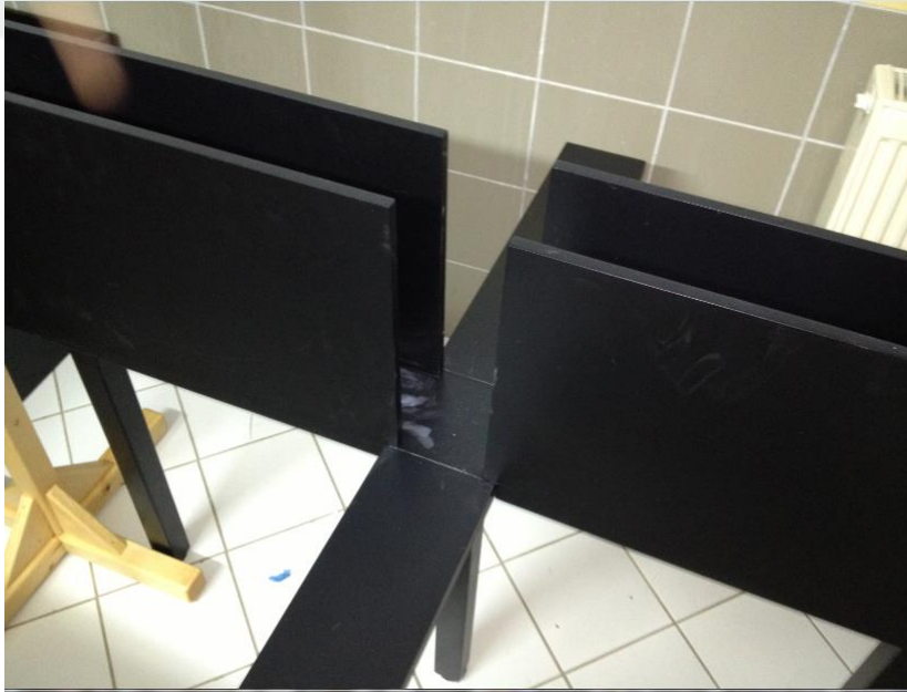
Çizim 3.3. İki kapalı ve iki açık koldan oluşan yükseltilmiş artı düzenek. Düzeneğin tepesinde hayvanların davranışlarını kaydeden bir kamera düzeneği bulunmaktadır.
