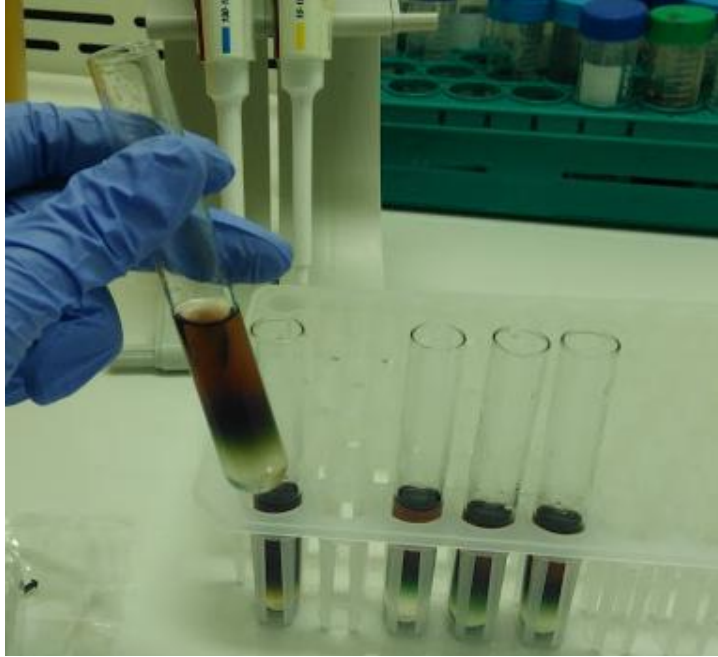
Çizim 4.1 Fenol-Sülfürik asit deneyi
