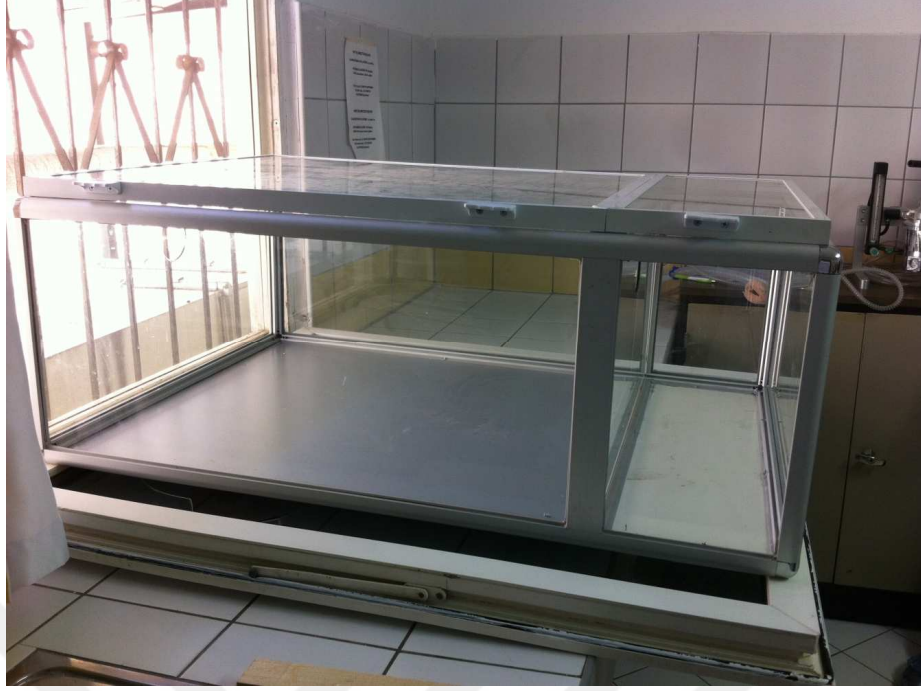
Çizim 3.2. Sıçanların formaldehit soluduğu deney kabini.
