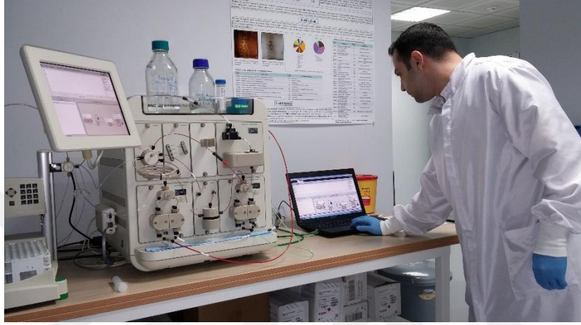
Çizim 3.7. rTFF'nin Protein A Kolon Kromatografisi ile NGC Sistemi Kullanılarak Safılaştırılması
