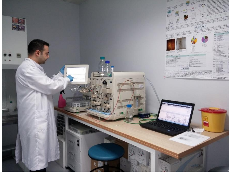
Çizim 3.9. rTFF'nin Ni-NTA Kolon Kromatografisi ile NGC Sistemi Kullanılarak Saflaştırılması
